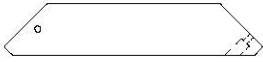
E13 CALE DE LA PLATEFORME - W4L16880 (x2) | 1 3/8 po x 3 3/8 po x 16 7/8 po (36x86x428)
