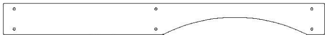
K8 LISSE MURALE ARQUÉE - W4L16591 (x1) 5/8 po x 5 1/4 po x 54 1/8 po (16x134x1375)
