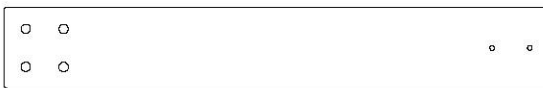
H81 | MONTANT DE CALE DE TOBOGGAN - W4L13301 (x2) | 1 po x 3 3/8 po x 22 7/8 po (24x86x580)
