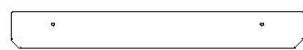
N3 | TABLETTE DE FENÊTRE GAUCHE - W4L06415 (x1) | 5/8 po x 2 3/8 po x 19 1/8 po (16x60x485)
