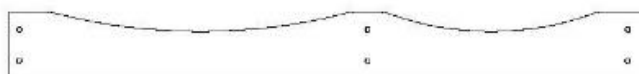
G9 | RAIL DE PLATEFORME SUPÉRIEUR - W4L12299 (x1) | 1 po x 5 1/4 po x 50 1/8 po (24 x 134 x 1 272)
