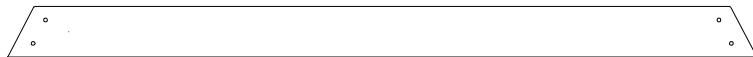
G12 CARTE DE MISE À LA TERRE - W4L18497 (x1) 1"x5 1/4"x78 1/8" (24x134x1984)
