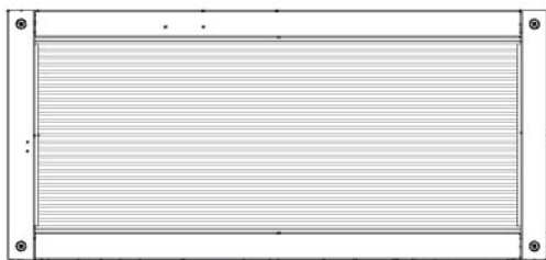
WA06 ASSEMBLAGE DE FENÊTRE - W2A04205 (x1) 1 7/8"x21 13/16"x47 3/16" (48x554x1094)
