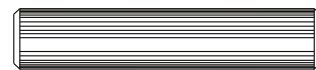
J Wooden dowel/ Clavija de mad/ Manchon en boisera X 6 (Ø8x30 mm)
