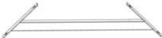
TB01 ASSEMBLAGE DE CONTREVENTEMENT DE TABLE - A4M05024 (x4) 20 po x 20 po x 1 9/16 po (40 x 508,6 x 508,6)
