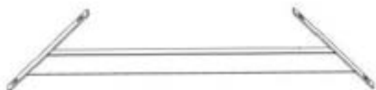
TB01 ASSEMBLAGE DE CONTREVENTEMENT DE TABLE - A4M05024 (x7) 20 po x 20 po x 1 9/16 po (40 x 508,6 x 508,6)
