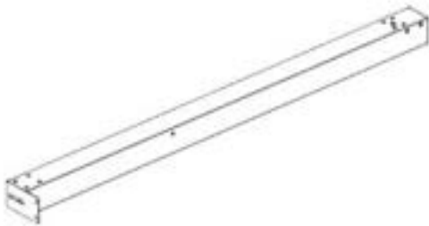
P02 POTEAU - A4M04949 (x1) 87 7/8 po x 7 7/8 po x 4 3/4 po (120 x 200 x 2232)
