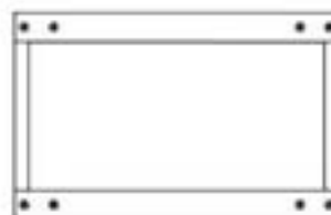
L01 ASSEMBLAGE DU CHÂSSIS À LAMELLES - A4M05408 (x2) 17 5/16 po x 11 po x 1 9/16 po (40 x 280 x 439)
