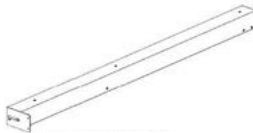
P04 POTEAU - A4M04970 (x1) 87 7/8 po x 7 7/8 po x 4 3/4 po (120 x 200 x 2232)
