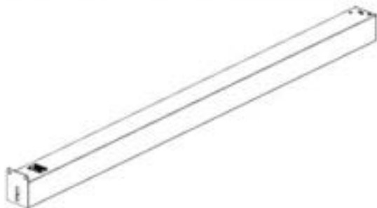
P05 POTEAU - A4M05016 (x1) 86 7/8 po x 5 7/8 po x 4 3/4 po (120 x 150 x 2206)
