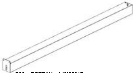
P06 POTEAU - A4M05017 (x1) 86 7/8 po x 5 7/8 po x 4 3/4 po (120 x 150 x 2206)
