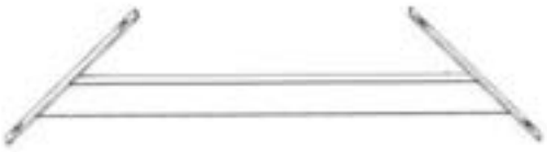
TB05 ASSEMBLAGE DU CONTREVENTEMENT DE LA TABLE - A4M05035 (x2) 17 7/8 po x 17 7/8 po x 1 9/16 po (40 x 453,6 x 453,6)
