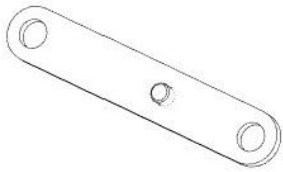
F03 SANGLE DE LIAISON - A4M02229-01 (x2) 1/8"x11/16"x3 13116" (3x17x97)
