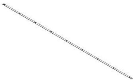
F01 BARRE PLATE - A4M02585 (x2) 1/16"x1"x110 3/4" (2x25x2813)
