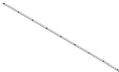
F01 BARRE PLATE - A4M02585 (x4) 1/16"x1"x110 3/4" (2x25x2813)
