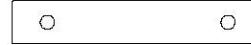
H06 | PELDAÑO DE LA ESCALERA DE CUERDA - W4L15982 (x6) | 1"x3 3/8"x19 5/8" (24x86x500)
