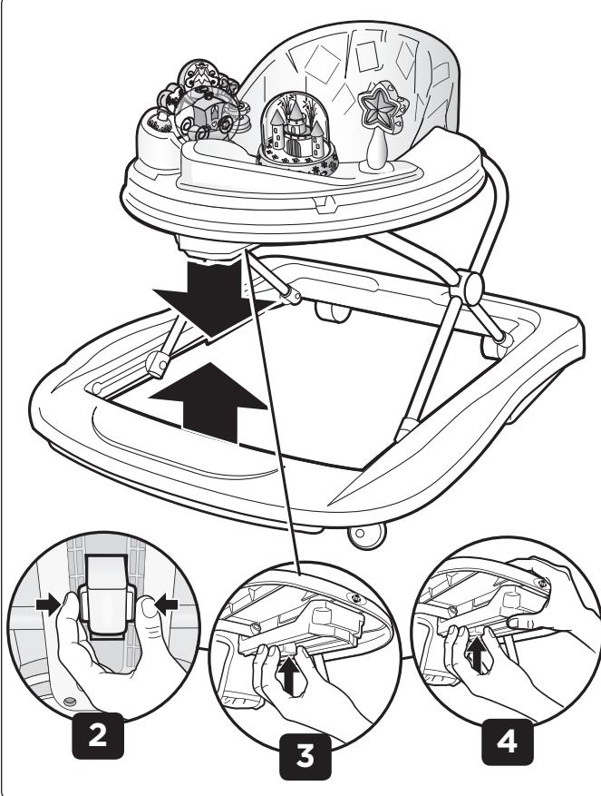
**1 Ajuste apropiado de la altura:** La altura puede ajustarse a tres posiciones diferentes. El bebé sólo debe tocar el piso con la parte anterior de la planta del pie **1**.
