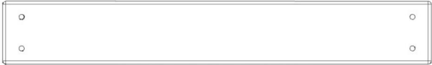
N11 EMPALME DE SOBREMESA - W4L21304 (x1) 5/8" x 2-3/8" x 16-1/16" (16 x 60 x 408)
