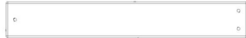
NR04 PLANCHE DE PROTECTION DU CHAUFFE-SAUNA - W4L22412 (x5) 13/16 po x 2 3/8 po x 16 15/16 po (20 x 60 x 430)
