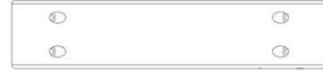
OR02 CONTREVENTEMENT D'ANGLE - W4L21946 (x2) 1 3/16 po x 2 3/8 po x 10 7/8 po (30 x 60 x 276)
