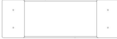
W02 (x3) ENTRETOISE DE PIED - W4L22399 1 15/16 po x 3 3/8 po x 10 1/4 po (30 x 86 x 261)
