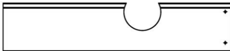
OJ17 PLANCHE MURALE - W4L22394 (x1) 1 3/16 po x 5 1/4 po x 24 3/4 po (30 x 134 x 629)
