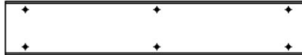
OG08 TAQUET DE SIÈGE - W4L22384 (x2) 1 3/16 po x 3 3/8 po x 19 1/8 po (30 x 86 x 486)
