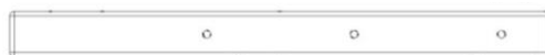
OO01 TAQUET DE LATTE - W4L22404 (x1) 1 3/16 po x 1 3/16 po x 14 po (30 x 30 x 355)
