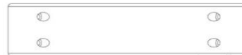
OR02 CONTREVENTEMENT D'ANGLE - W4L21946 (x2) 1 3/16 po x 2 3/8 po x 10 7/8 po (30 x 60 x 276)
