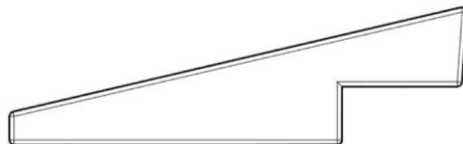
W03 (x2) CONTREVENTEMENT D'ANGLE - W4L22409 1 15/16 po x 3 3/8 po x 11 1/4 po (50 x 86 x 285)
