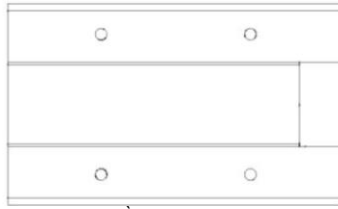
OG11 (x1) PLANCHE À GOULOTTE - W4L22388 1 3/16 po x 3 3/8 po x 5 11/16 po (30 x 86 x 144)
