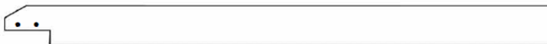
B02 POUTRE DE PIGNON - A4M04152 (x2) 1 9/16 po x 5 1/4 po x 71 15/16 po (39x134x1827)
