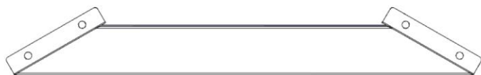
R01 CONTREVENTEMENT DE CHEVRONS - A4M04329 (x2) 1 9/16 po x 4 3/8 po x 60 1/8 po (40x111x1527)
