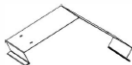
A4M04328 RABOUTAGE DU (x1) COUVRE-FAÎTE
