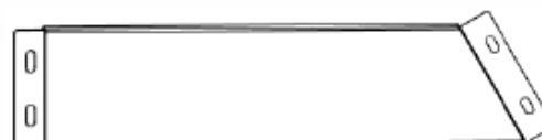
B09 SUPPORT DE PIGNON - A4M04319 (x2) 1 1/2 po x 5 15/16 po x 24 5/8 po (38x152x625)
