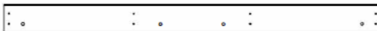
AD06 SUPPORT DE FAÎTE - W4L21549 (x1) 15/16 po x 4 po x 50 3/16 po (24x102x1274)
