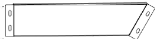
B08 SUPPORT DE PIGNON - A4M04318 (x2) 1 1/2 po x 5 15/16 po x 24 5/8 po (38x152x625)
