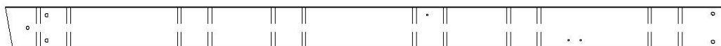
A1 | POUTRE DE LA BALANÇOIRE - W4L15713 (x1) | 3/8 po x 5 1/4 po x 89 1/2 po (86x134x2274)
