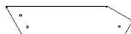
H12 | PLANCHE DE RIVE DU PIGNON - W4L16458 (x4) | 1 po x 3 3/8 po x 14 5/8 po (24 x 86 x 370)
