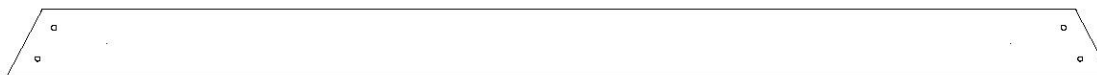
G50 PLANCHE DE SOL - W4L16465 (x1) 1 po x 5 1/4 po x 86 3/4 po (24x134x2202)
