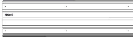
5500 29GA STEEL SHEETING - A4M05500 (x1) 1/4"x13"x46 7/16" (7x330x1179)
