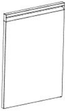
D1 DOOR ASSEMBLY - A4M05487 (x1) 22 3/8"x18 7/8"x7/8" (22x480x568)
