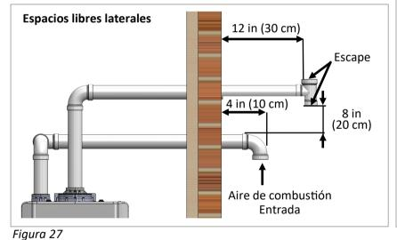
Ventilación horizontal y tuberías de aire de combustión - Entrada 60 in (152 cm) Min. Escape 12 in 12 in (30 cm) (30 cm) Min. Min. -Entrada 12 in 12 in 12 in (30 cm) (30 cm) (30 cm) Min. Min. Min. Terreno/Grado/Nivel de nieve Indica la zona en la que no se puede localizar la toma.
