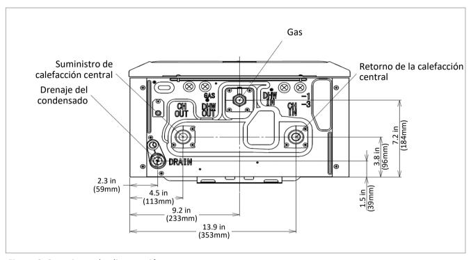
Figura 6: Conexiones de alimentación
