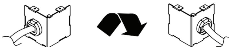
Étape 3. Réinstallez le couvercle du cordon d'alimentation sur la PDU à l'aide des quatre vis.
