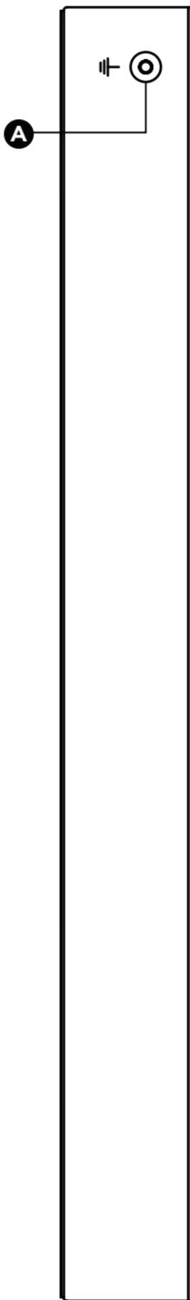
**A. Goujon de mise à la terre** - Utilisé pour la mise à la terre de la PDU
