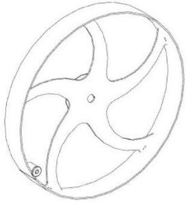
W01 ASSEMBLAGE DE ROUE - A4M02146 (x1) 2 3/8"x7" (59.7x178)
