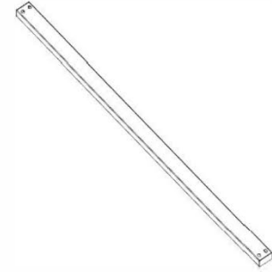
U03 RAIL SUPÉRIEUR - A4M02149 (x1) 1"x1 1/2"x35 1/4" (25x38x896)
