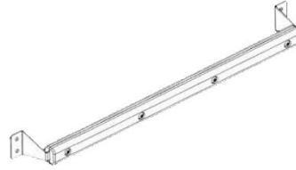
H01 ASSEMBLAGE DE POIGNÉE DE PORTE - A4M02761 (x1) 2 3/8"x3 3/4"x30 1/4" (60x95x769)
