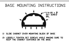
3) TIGHTEN SCREWS IN A CRISS-CRUSS PATTERN
