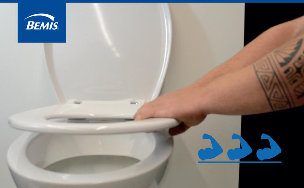
**Si l'abattant a été correctement installé, il résistera sans effort au test de traction latérale de 30 kg conformément à la norme DIN 19516.**
