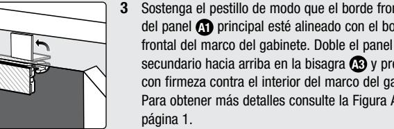
3 Sostenga el pestillo de modo que el borde frontal del panel principal caiga. Retire el soporte de papel del panel (A1) principal. Gire el panel principal hacia arriba y presínelo firmemente contra la parte inferior del gabinete.
