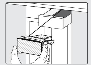
1 Antes de instalar la cerradura, sujetela de modo que el panel (A1) principal esté alineado con la parte delantera del cajón. Si el pestillo y el cierre encajan entre la caja del gabinete y la parte superior del cajón como se muestra, la cerradura se instalará correctamente.
