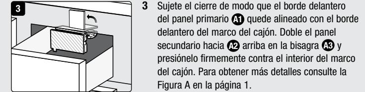
3 Sujete el cierre de modo que el borde delantero del panel primario (A1) quede alineado con el borde delantero del marco del cajón. Doble el panel secundario (A2) hacia arriba en la bisagra (A3) y presínelo firmemente contra el interior del marco del cajón. Para obtener más detalles consulte la Figura A en la página 1.
