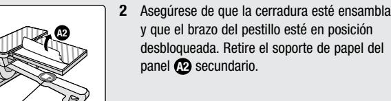
2 Asegúrese de que la cerradura esté ensamblada y que el brazo del pestillo se encuentre en posición desbloqueada. Retire el soporte de papel del panel secundario (A2).
