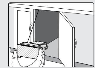
1 Con la puerta del gabinete abierta, mida aproximadamente 2.5 cm (1 pulgada) desde la otra puerta (si se instala en un armario de dos puertas) o desde la pared lateral del armario (si se instala en un armario de una puerta) para determinar dónde colocar la cerradura.
