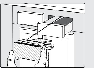
1 Antes de instalar la cerradura, sujetela de modo que el panel (A1) principal esté alineado con la parte delantera del cajón. Si el pestillo y el cierre encajan entre el fondo del marco y la parte superior del cajón como se muestra, la cerradura funcionará correctamente.
