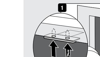
1 Utilizando una broca de 7/64", taladre previamente los agujeros de los tornillos para el retén a 0.9 cm (3/8 de pulgada) de profundidad. Tenga cuidado de no perforar el gabinete. Use un destornillador Phillips para sujetar dos de los tornillos provistos a través de las aberturas de retención como se muestra.
