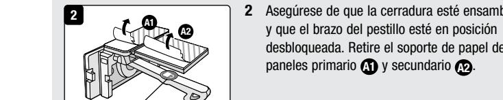
2 Asegúrese de que la cerradura esté ensamblada y que el brazo del pestillo se encuentre en posición desbloqueada. Retire el soporte de papel de los paneles primario (A1) y secundario (A2).
