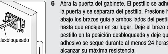
6 Abra la puerta del gabinete. El pestillo se adherirá a la puerta y se separará del pestillo. Presione hacia abajo los brazos guía a ambos lados del pestillo hasta que encajen en su lugar. Deje el brazo del pestillo en la posición desbloqueada y deje que el adhesivo se seque durante al menos 24 horas para alcanzar su máxima resistencia.
