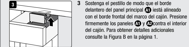
3 Sujete el cierre de modo que el borde delantero del panel primario (A1) quede alineado con el borde delantero del marco del cajón. Doble el panel secundario (A2) hacia arriba en la bisagra (A3) y presínelo firmemente contra el interior del marco del cajón. Para obtener más detalles consulte la Figura B en la página 1.
