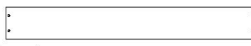
M09 (x1) | PLANCHE DE MUR D'ESCALADE - W4L13920 5/8 po x 3 3/8 po x 26 1/4 po (16 x 86 x 668)
