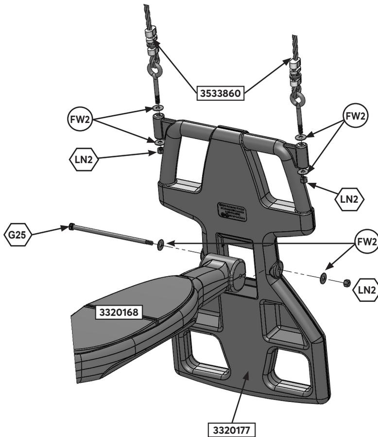
**⚠ AVERTISSEMENT :** Le filetage du boulon ne doit pas dépasser l'écrou de plus de la moitié du filetage
