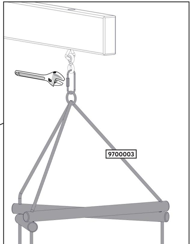
**Attention :** les mousquetons à bague fileté doivent être installés avec le portique complètement au sol recouvrant les filetages, puis serrés conformément aux instructions.
