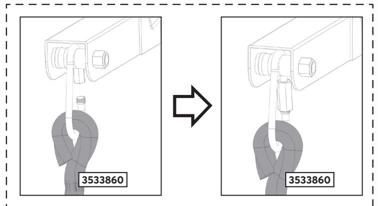
**Attention :** les mousquetons à bague fileté doivent être installés avec le portique complètement au sol recouvrant les filetages, puis serrés conformément aux instructions.
