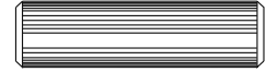
I WOODEN DOWEL/ CLAVIJA DE MADERA/ MANCHON EN BOIS X 22 (Ø8 X 30MM)
