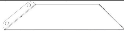
D06 CORBEAU - A4M01832 (x1) 2 3/4 po x 5 7/8 po x 24 13/16 po (70x149x631)
