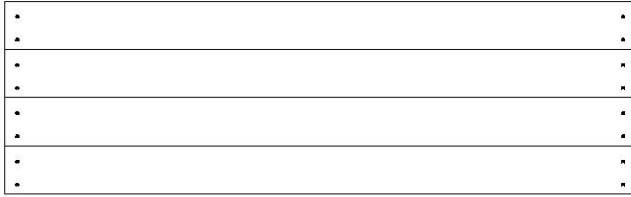
RP1 | PANNEAU DE FAÎTE DE TOIT - W2A03276 (x2) | 1 5/8 po x 20 5/8 po x 59 po (42x511x1676)
