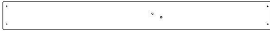
G05 | PLANCHE DE MUR D'ESCALADE - W4L15974 (x5) | 1 po x 5 1/4 po x 51 1/2 po (24x134x1307)
