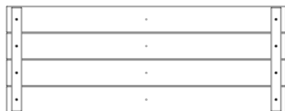
FP1 | PANNEAU DE SOL INFÉRIEUR - W2A02648 (4) | 1 5/8"x13 1/2"x35 3/8" (40x344x897)
