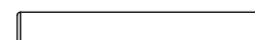
M METAL PIN/ PIN EN MÉTAL/ AGUJA DE METAL X 2 (Ø4 X 30MM)
