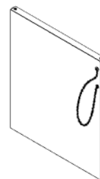
O3 ASSEMBLAGE DU PANNEAU LATÉRAL DE L'ARMOIRE DU FOUR À PIZZA- A4M03077 (x1) 1 3/4"x23 5/16"x26 7/16" (44x592x672)
