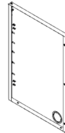
S3 MONTAGE PANNEAU LATÉRAL DE L'ARMOIRE D'ÉVIER - A4M03095 (x1) 1 3/8"x23 3/8"x33 3/8" (35x594x848)
