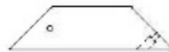
H20 | CALE DE PLATEFORME - W4L14942 (x8) | 1 po x 3 3/8 po x 13 po (24 x 86 x 330)
