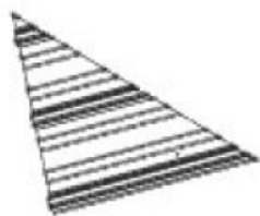
A4M02902-2 | TÔLE D'ACIER 29 GA (x2)
