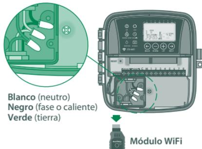
**ADVERTENCIA:** NO enchufe el transformador hasta que haya finalizado y verificado todas las conexiones de cableado.
