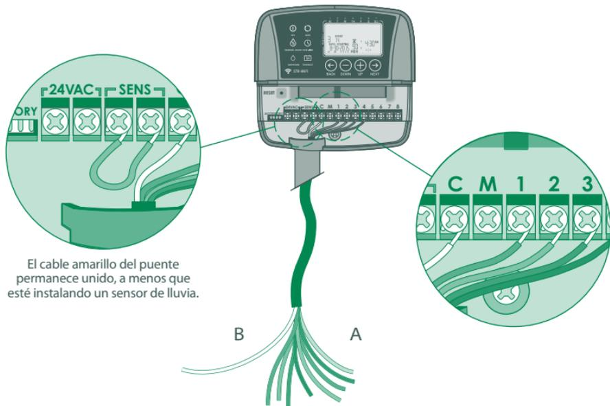
El cable amarillo del puente permanece unido, a menos que esté instalando un sensor de lluvia.
