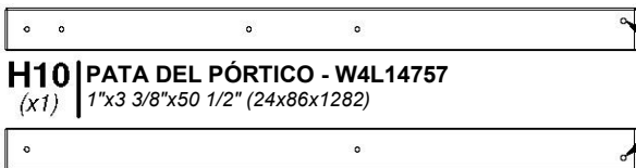
H10 | PATA DEL PÓRTICO - W4L14757 (x1) | 1"x3 3/8"x50 1/2" (24x86x1282)
