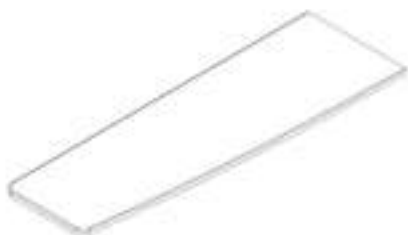
M7 COMPTOIR DE BAR GAUCHE - A4M05967 (x1) 11/16"x14 1/16"x43 7/16" (18x358x1103)
