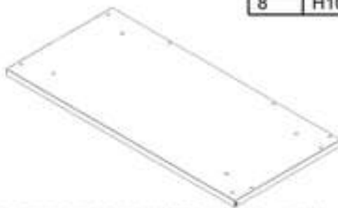
T3 - PANNEAU DE L'ARMOIRE D'ANGLE - A4M03044 (x1) 1 1/4"x24 1/8"x51 7/8" (32x612x1317)
