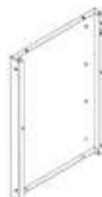
G1 MONTAGE DU MUR LATÉRAL D'ARMOIRE GAUCHE - A4M03029 (x1) 2 9/16"x23 3/8"x33 3/8" (65x594x848)
