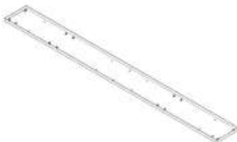
T8 MONTAGE DE TABLE BAR- A4M03023 (x1) 1"x8 7/8"x86 1/4" (25x225x2190)
