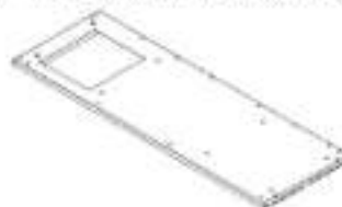
T7 ASSEMBLAGE DE PANNEAUX DE MARBRE POUR MEUBLE ÉVIER - A4M03142 (x1) 1 1/4"x24 1/8"x70 13/16" (32x612x1798)
