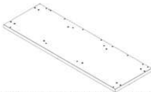
F5 MONTAGE DE PLANCHER DE L'ARMOIRE D'ÉVIER - A4M03092 (x1) 2 5/8"x23 3/8"x72 3/16" (66x594x1834)
