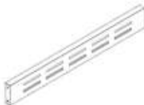
O8 - PANNEAU DE VENTILATION - A4M03078 (x1) 1 3/16"x4"x31 7/16" (30x102x798)
