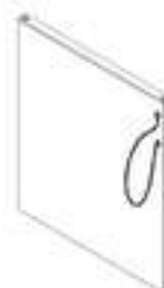
O3 ASSEMBLAGE DU PANNEAU LATÉRAL DE L'ARMOIRE M - A4M03077 (x1) 1 3/4"x23 5/16"x26 7/16" (44x592x672)
