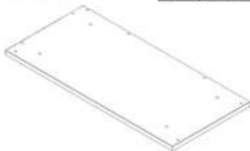
T1 PANNEAU DE L'ARMOIRE D'ANGLE L - A4M03034 (x1) 1 1/4"x24 1/8"x51 7/8" (32x612x1317)
