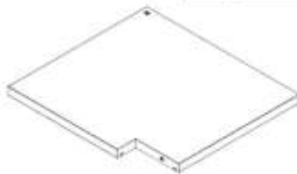
C2 MONTAGE DE L'ÉTAGÈRE DE L'ARMOIRE D'ANGLE - A4M03038 (x1) 1 1/4"x23 1/8"x25 7/16" (32x588x646)
