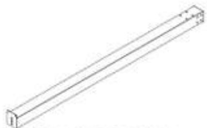
P02 POTEAU AVANTE- A4M02977 (x1) 4 3/4"x6 1/8"x96 5/8" (120x155x2455)
