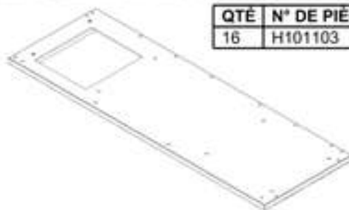
T7 MONTAGE DE PANNE DE L'ARMOIRE D'ÉVIER- A4M03142 (x1) 1 1/4"x24 1/8"x70 13/16" (32x612x1798)
