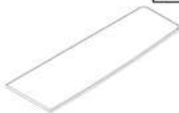
M6 COMPTOIR DE BAR À DROITE - A4M05966 (x1) 11/16"x14 1/16"x43 7/16" (18x358x1103)
