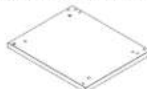
T5 ARMOIRE PANNEAU DE MARBRE R - A4M03069 (x1) 1 1/4"x20"x24 1/8" (32x508x612)
