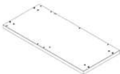
F1 MONTAGE DE PANNEAU DE PLANCHER D'ARMOIRE DE COIN L - A4M03028(x1) 2 5/8"x23 3/8"x51 7/8" (66x594x1317)
