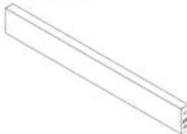
A1 MONTAGE DE POUTRE LATÉRALE DE L'ARMOIRE D'ANGLE- A4M03032 (x1) 1"x2 3/4"x22 1/4" (25x70x565)
