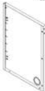
S3 PANNEAU LATÉRAL DE L'ARMOIRE D'ÉVIER - A4M03095 (x1) 1 3/8"x23 3/8"x33 3/8" (35x594x848)
