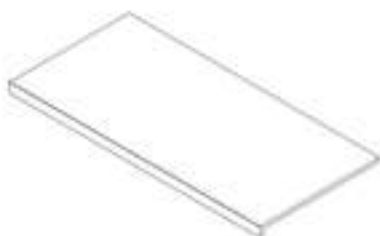
M1 COMPTOIR D'ARMOIRE D'ANGLE - A4M05968 (x2) 1 15/16"x24 13/16"x51 7/8" (50x630x1317)
