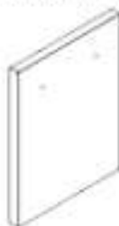
D11 MONTAGE DU PANNEAU DE POUBELLE - A4M03084 (x1) 1 5/16"x16 1/2"x21 5/8" (34x419x550)
