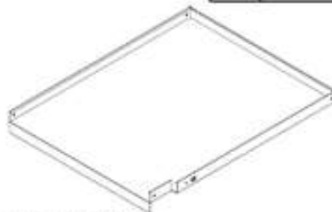
C3 ÉTAGÈRE D'ARMOIRE A4M03054 (x1) 2 5/16"x18 1/4"x22 11/16" (59x464x577)
