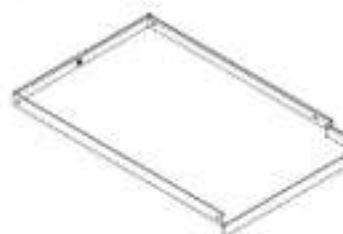
C5 ÉTAGÈRE D'ARMOIRE - A4M03074 (x1) 2 3/8"x14 7/8"x23 1/16" (60x378x585)
