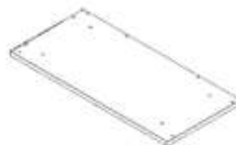
T1 PANNEAU DE L'ARMOIRE D'ANGLE EN MARBRE - A4M03034 (x1) 1 1/4"x24 1/8"x51 7/8" (32x612x1317)
