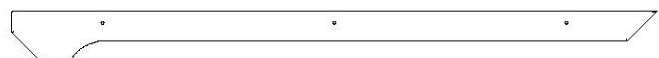
M34 | BORDURE DE TOIT - W4L06560 (x4) | 5/8 po x 3 3/8 po x 42 po (16x86x1068)
