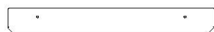
N3 | TABLETTE DE FENÊTRE GAUCHE - W4L06415 (x1) | 5/8 po x 2 3/8 po x 19 1/8 po (16x60x485)
