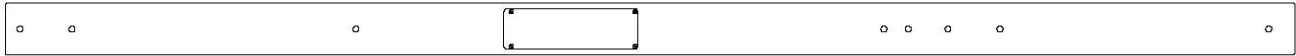
E15 | MONTANT AVANT DROIT - W2A03505 (x1) | 1 3/8 po x 3 3/8 po x 84 po (36x86x2135)
