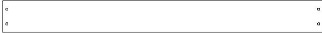
G6 | PLANCHE DE SOL - W4L16883 (x2) | 1 po x 5 1/4 po x 52 1/2 po (24x134x1335)
