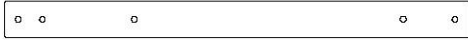
F2 | MONTANT DE PLANCHER-TERRASSE - W4L06441 (x1) | 1 3/8 po x 2 3/8 po x 30 3/8 po (36x60x770)
