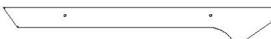
M33 | BORDURE DE TOIT - W4L06559 (x4) | 5/8 po x 3 3/8 po x 25 5/8 po (16x86x652)
