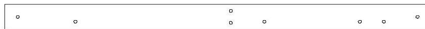
H4 | LISSE DE PLANCHER - W4L06396 (x1) | 1 po x 3 3/8 po x 54 7/8 po (24x86x1394)
