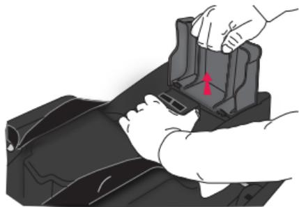
Voltee la base. Mientras sostiene la base abajo con una mano, jale el soporte de ajuste de nivelación hacia arriba para desacoplar las lengüetas de bloqueo.
