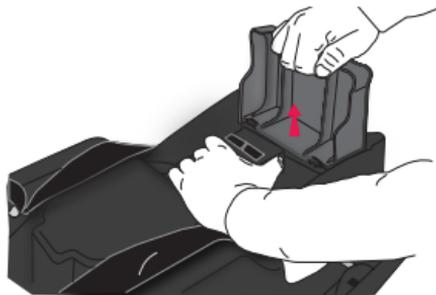
Voltee la base. Mientras sostiene la base abajo con una mano, jale el soporte de ajuste de nivelación hacia arriba para desacoplar las lengüetas de bloqueo.
