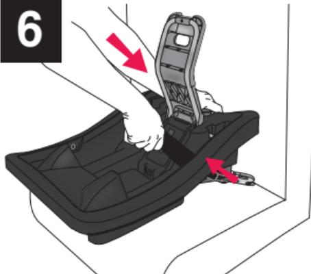
Usando todo su peso, empuje la base contra el asiento del vehículo, mientras jala hacia arriba la correa para retirar toda la holgura del ensamblado de conectores de anclaje inferior.
