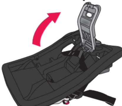
Empuje hacia abajo la traba de seguridad mientras empuja hacia atrás la lengüeta de liberación de la traba de seguridad. Levante la traba de seguridad para dejar a la vista la trayectoria del cinturón.
