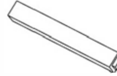
F05 PORTE-CLÉS - A4M02226 (x1) 1/2"x1/2"x3 3/4" (13x13x95)
