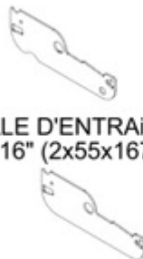
L03 PLAQUE LATÉRALE DE PERSIENNE - A4M04138 (x1) 1/16"x2 3/16"x6 9/16" (2x55x167)
