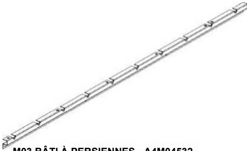
M03 BÂTI À PERSIENNES - A4M04532 (x1) 1"x1 15/16"x65 13/16" (25x48.5x1672)
