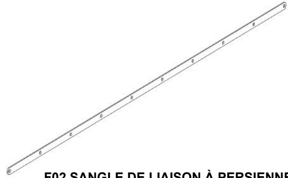
F02 SANGLE DE LIAISON À PERSIENNE -A4M04121 (x4) 1/8"x13/16"x61 3/8" (3x20x1559)
