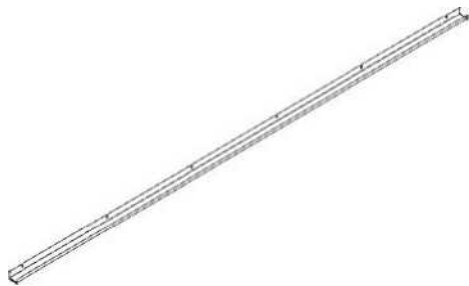
G01 GOUTTIÈR-A4M01993 (x1) 1 9/16"x1 15/16"x108 7/8" (40x50x2765)
