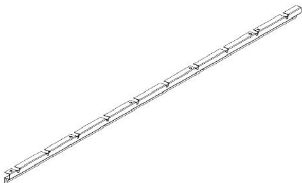
M03 BÂTI À PERSIENNES - A4M04532 (x2) 1"x115/16"x6513/16" (25x48.5x1672)
