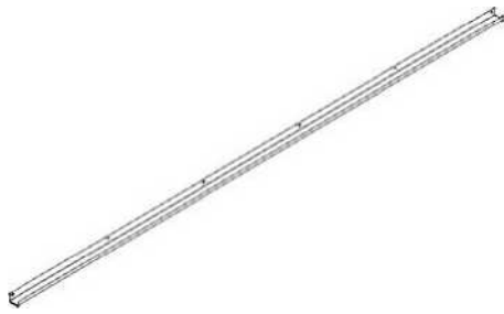
G03 GOUTTIÈR - A4M04120 (x1) 1 9/16"x1 15/16"x111111/16" (40x50x2837)
