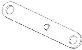
F03 - SANGLE DE LIAISON - A4M02229 (x1) 1/2"x11/16"x3 13/16" (13x17x97)
