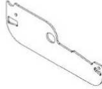
L03 PLAQUE LATÉRALE DE PERSIENNE - A4M04138 (x32) 1/16"x2 3/16"x6 9/16" (2x55x167)
