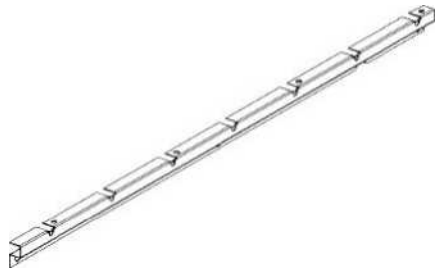
M01 BÂTI À PERSIENNES - A4M04530 (x1) 1 "x1 15/16"x45 5/8" (25x49x1159)
