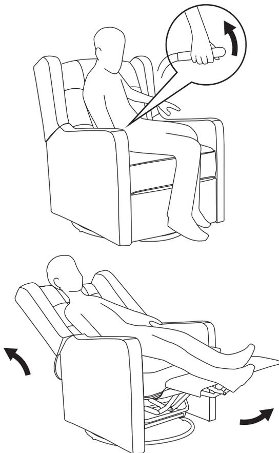
Pour que le fauteuil passe en position inclinée, il suffit de tirer sur le bras situé à l'intérieur de la base (B), du côté droit, et d'appuyer son dos contre le dossier.
