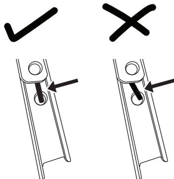
S'assurer que le mécanisme de verrouillage de chaque rail métallique est aligné au **centre**.
