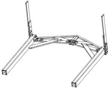
ASSEMBLAGE DES POTEAUX ET PIGNONS
