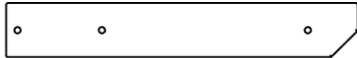
M14 SUPPORT DE SIÈGE DE TABLE DE PIQUE-NIQUE - W4L16050 (x2) 5/8 po x 3 3/8 po x 22 po (16 x 86 x 558)
