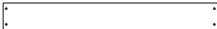
M74 | PLANCHE DE MUR D'ESCALADE - W4L16071 (x10) 5/8 po x 3 3/8 po x 26 5/8 po (16 x 86 x 675)
