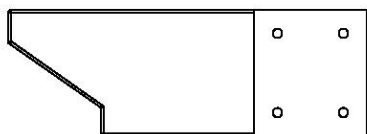
D1 | EXTRÉMITÉ DE SOLIVE - W4L16247 (1) | 1 7/16 po x 5 1/4 po x 15 po (36x134x381)
