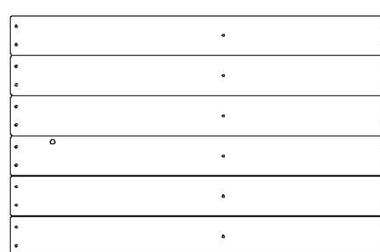
HH5 | PANNEAU DE PLANCHER - W2A03076 (x1) | 1 1/4 po x 20 9/16 po x 32 7/16 po (32 x 522 x 824)
