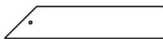
N04 | PLANCHE DE RIVE DU PIGNON - W4L16079 (x4) 5/8 po x 2 3/8 po x 11 7/8 po (16 x 60 x 301)
