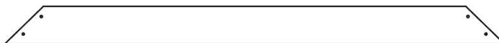
M04 | PLANCHE DE RIVE DU PIGNON - W4L16065 (x2) | 5/8 po x 3 3/8 po x 44 po (16 x 86 x 1118)
