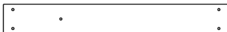
G12 | LISSE DE PLANCHER - W4L16012 (x2) 1 po x 5 1/4 po x 40 1/8 po (24 x 134 x 1018)
