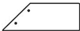
M22 | PLANCHE DE RIVE DU PIGNON - W4L16058 (x4) 5/8 po x 3 3/8 po x 9 1/2 po (16 x 86 x 241)
