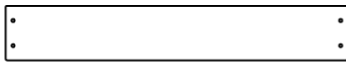
M27 | PANNEAU MURAL INFÉRIEUR - W4L16062 (x7) | 5/8 po x 3 3/8 po x 2 1/8 po (16 x 86 x 54)
