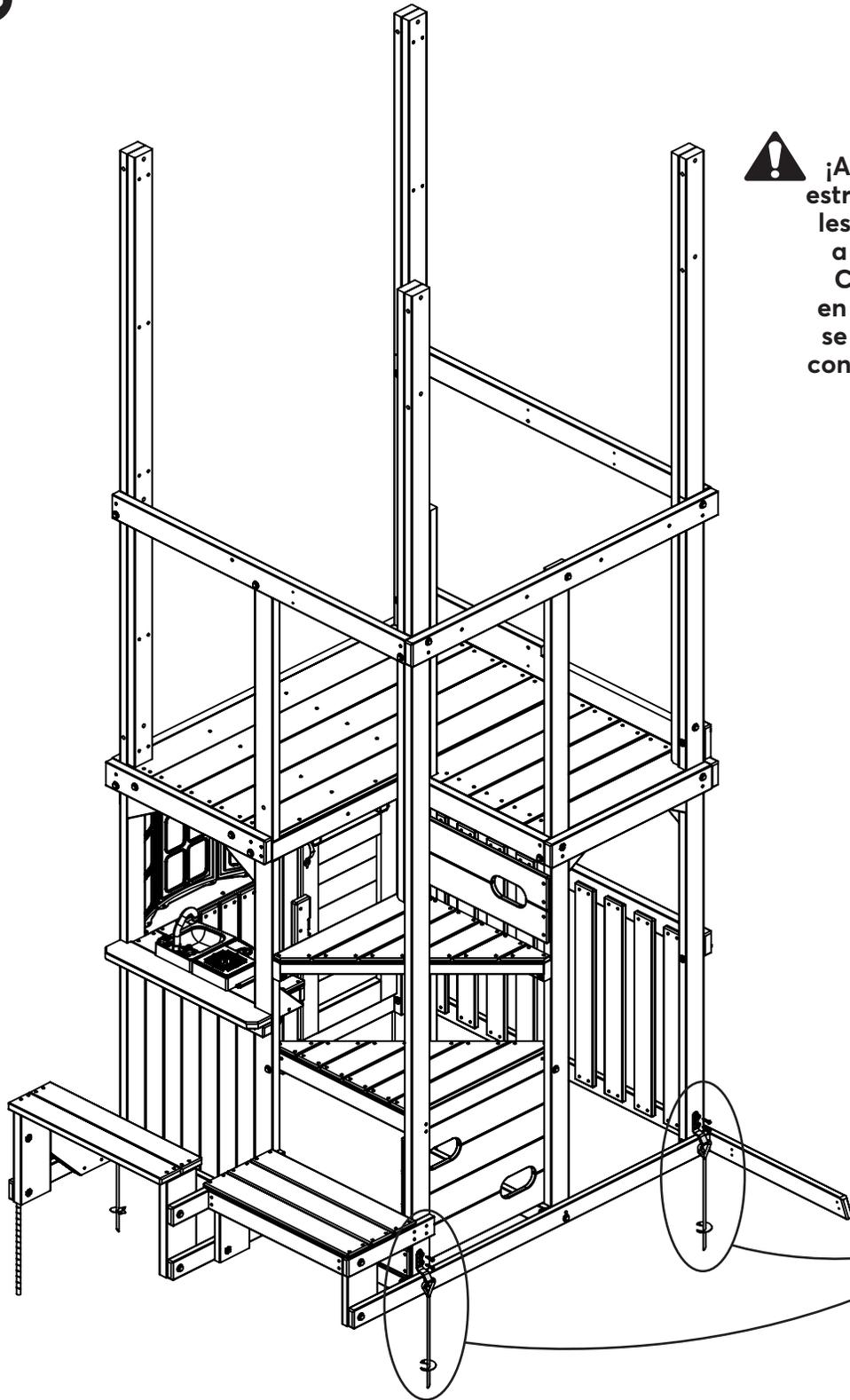
**¡Advertencia!** A fin de evitar que la estructura vuelque y prevenir posibles lesiones, las estacas deben clavarse a una profundidad de 13" (33 cm).
