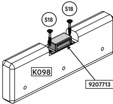
Cierre la puerta y centre verticalmente el cierre magnético con la placa de cierre para el montaje
