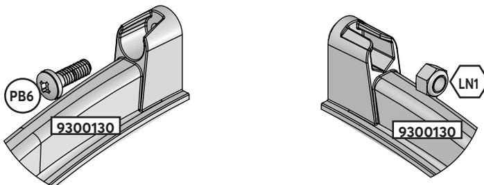
**Nota:** El juego inferior de abrazaderas puede girarse 90° para instalar los pernos y que el montaje resulte más sencillo.
