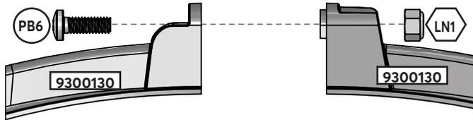
Una vez que las abrazaderas hayan quedado unidas a los codos, fíjelas por los dos extremos con dos pernos de cabeza alomada y tuercas de seguridad.
