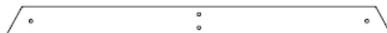
E79 SUPPORT D'EXTRÉMITÉ - W4L22159 (x1) 1 1/2 po x 3 1/2 po x 44 po (36 x 86 x 1120)
