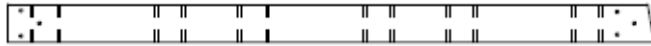
A01 POUTRE DE BALANÇOIRE - W4L22161 (x1) 3 3/8 po x 5 1/4 po x 89 1/2 po (86 x 134 x 2274)
