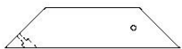
E11 CONTREVENTEMENT D'ANGLE - W4L22140 (x6) 1 1/8 po x 3 3/8 po x 14 5/8 po (30 x 86 x 373)
