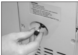
Figure 10. Remplacer le fusible situé sous le boîtier du moteur.
