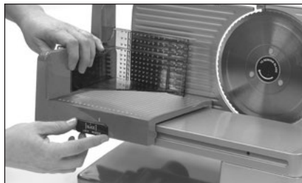
Figura 5. Cómo retirar el carro transportador de alimentos.
