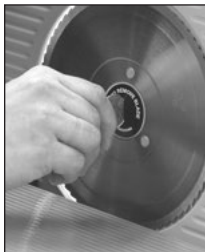
Figura 7. Girar el tornillo hacia la derecha para quitar la cuchilla.
