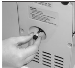
Figura 10. Cómo reponer el fusible ubicado debajo de la carcasa del motor.
