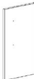
D6 ASSEMBLAGE DE LA PORTE - A4M05166 (x1) 25 3/16 po x 13 5/16 po x 15/16 po (24 x 338 x 639)
