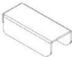
A5 SUPPORT D'ÉTAGÈRE - A4M03141 (x2) 5/8 po x 7/8 po x 2 1/16 po (16 x 22 x 53)
