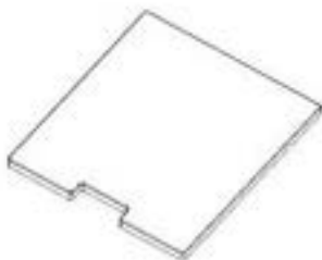
M5 COMPTOIR COUVRE-ÉVIER - A4M05949 (x1) 11/16 po x 14 3/4 po x 16 5/16 po (18 x 375 x 415)
