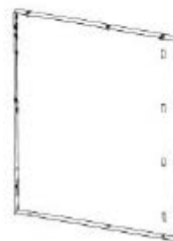
G7 ASSEMBLAGE DU PANNEAU ARRIÈRE - A4M06925 (x1) 33 3/8 po x 25 1/16 po x 1 3/16 po (30 x 637 x 848)
