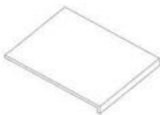
M4 COMPTOIR - A4M05155 (x1) 24 15/16 po x 19 3/16 po x 1 15/16 po (50 x 488 x 634)
