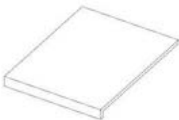
M3 COMPTOIR - A4M05154 (x1) 24 15/16 po x 19 3/16 po x 1 15/16 po (50 x 488 x 634)
