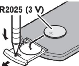
Insérez la pile CR2025 (3 V) avec les pôles positif (+) et négatif (-) orientés correctement.
