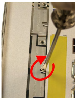
5 - Break the bottom rib
